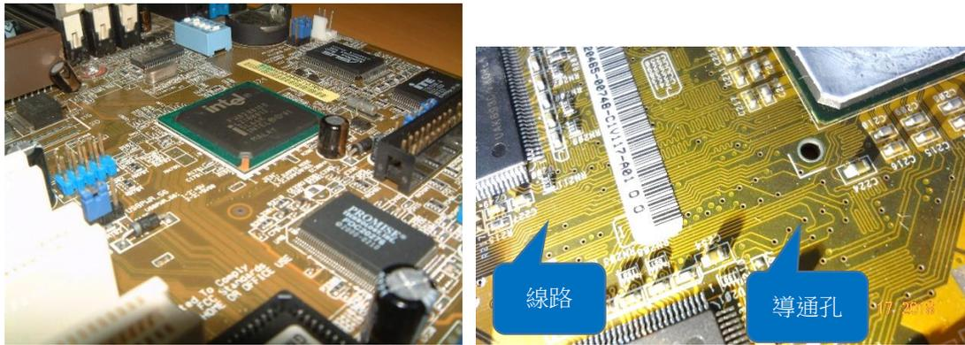
圖十五 (左圖)印刷電路板提供各種元件間傳通資訊的平台 (右圖)印刷電路板的線路與導通孔
