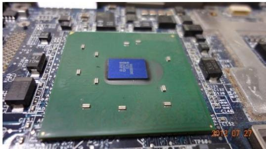
圖四 矽晶片元件/模組(矽晶片裸露在外)
