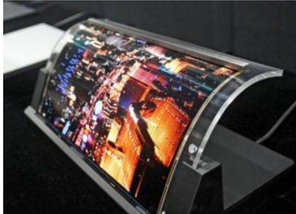
圖 4.7、使用噴墨列印製作之可撓曲 OLED 面板。
